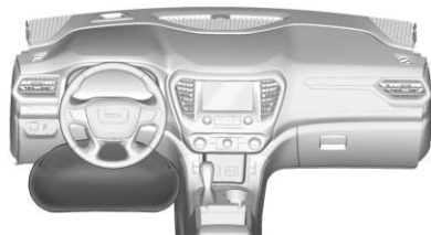
De knieairbag van de bestuurder zit onder de stuurkolom.
